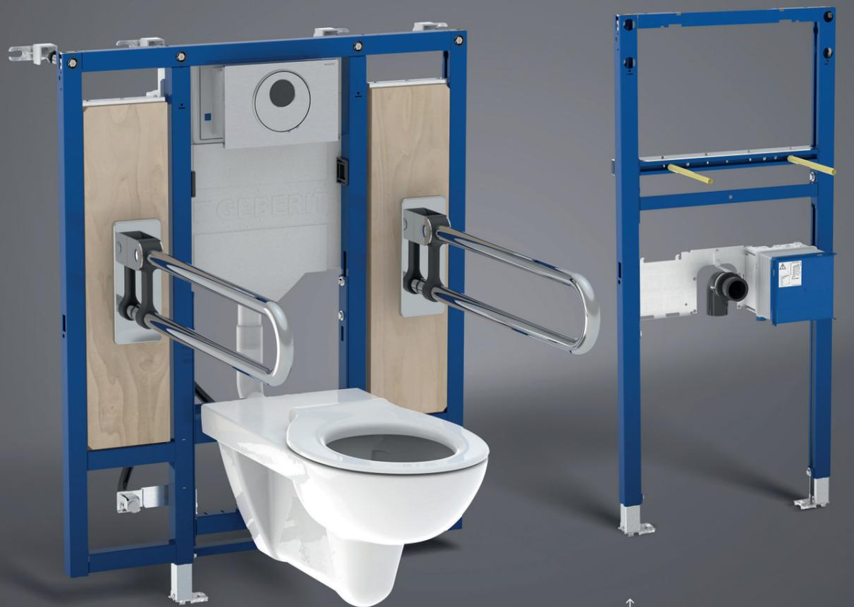
↑ WC-Montageelement mit Höhenverstellung und Montageplatten für Stütz- und Haltegriffe.
